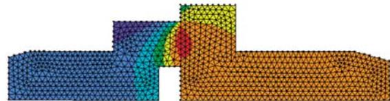
Геометрия поверхности уплотнений серии S спроектирована с помощью анализа методом конечных элементов (FEA) и компьютерного моделирования параметров жидкостного потока. Стабильно высокая эффективность и надежность уплотнений серии S объясняется минимальной деформацией поверхности за счет низкого тепловыделения.
