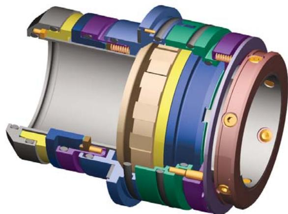
В уплотнительных кассетах S10 и S20 применяется один и тот же сальник серии S. Уникальное конструктивное решение «кассета в патроне» предельно упрощает обслуживание и замену уплотнений. Замена сводится к быстрой, надежной установке другой кассеты со всеми новыми деталями, тем самым позволяя избежать административных затрат на модернизацию.
